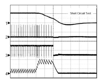
$\begin{array}{l} \text{CH1: } V_{\text{out}}, \ 1\text{V/Div, DC} \\ \text{CH2: } V_{\text{ugate}}, \ 20\text{V/Div, DC} \\ \text{CH3: } V_{\text{Lgate}}, \ 5\text{V/Div, DC} \\ \text{CH4: } I_{\text{L}}, \ 20\text{A/Div, DC} \\ \text{TIME: } 20\mu\text{s/Div} \end{array}$
