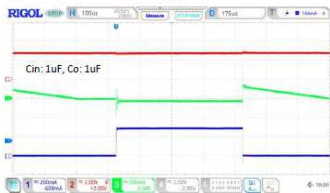
$V_{IN}=3.3V$ ,  $V_o=1.2V$
