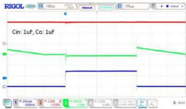
$V_{IN}=5V$ ,  $V_o=1.2V$
