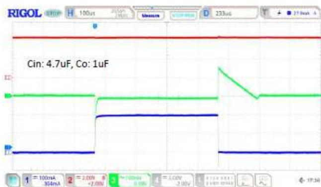
$V_{IN}=4.3V$ ,  $V_o=3.3V$
