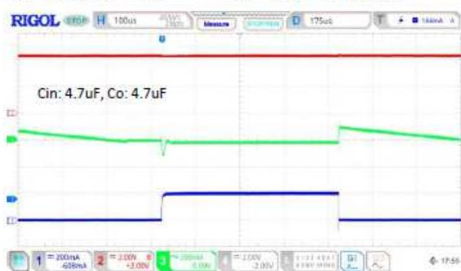
$V_{IN}=4.3V$ ,  $V_o=3.3V$
