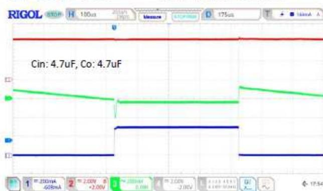
$V_{IN}=2.8V$ ,  $V_o=1.2V$
